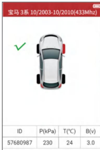
点击 按键，屏幕上会显示传感器的详细信息（包含传感器的 ID，压力，温度和电压值）。
