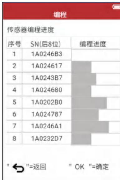
胎压传感器编程完成后，显示屏会显示传感器 SN(后 8 位) 和对应的 ID 号。
