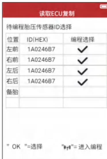
将待编程朗仁传感器放置在靠近编程设备顶部的位置，设备将自动检测附近的朗仁胎压传感器。
